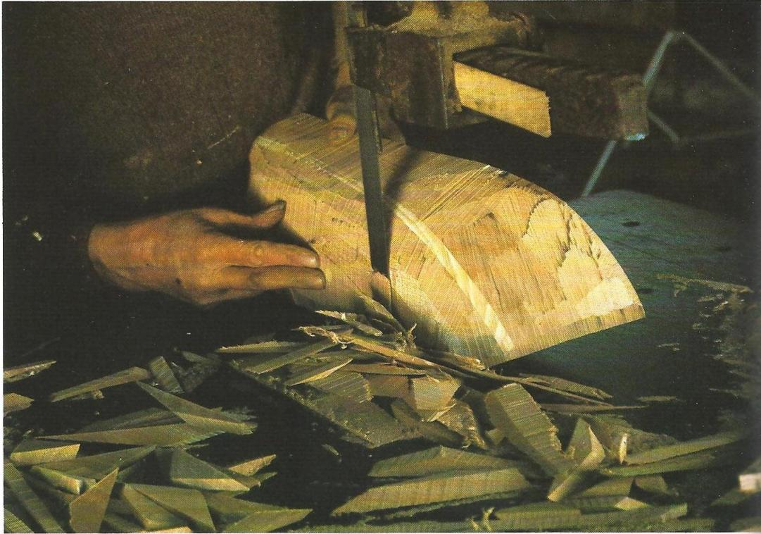
Élaborée d'après un dessin précis mais sommaire, la demi-maquette au 1/20<sup>e</sup> permet la représentation en relief du bateau fini. Elle est réalisée à partir de planchettes chevillées en un bloc homogène dégrossi à la scie circulaire, sculpté à la perceuse et poli au papier de verre.
